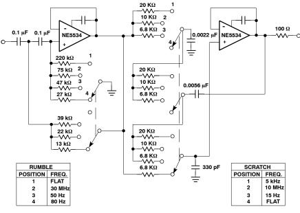
Figure 19. Rumble/Scratch Filter
